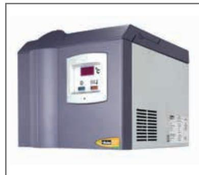
**Parker domnick hunter UHP-ZA 系列零级空气发生器**利用现有的压缩空气源,通过高温催化裂化,连续产生洁净、干燥、无烃类化合物的空气,烃类化合物总残留量低于 0.1ppm。流速范围从 1.0L/min 到 30L/min 的七种型号可供选择。
