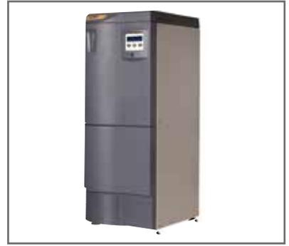
**Parker domnick hunter UHPN2 系列高纯氮气发生器**采用变压吸附技术 (PSA) 产生高纯氮气, 碳分子筛自动再生, 无须二次净化, 氮气纯度和流量稳定, 使用寿命长。流速范围从 0.75L/min 到 3L/min 多种型号可选。
