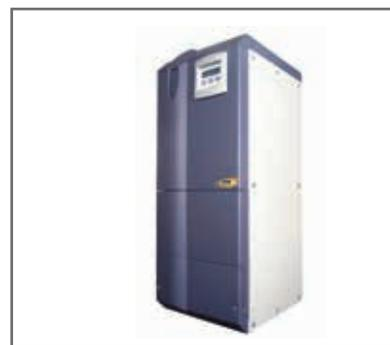
**Parker domnick hunter G6、G7 系列氮气空气一体机**采用变压吸附技术 (PSA) 产生高纯氮气, 碳分子筛自动再生, 无须二次净化, 氮气纯度和流量稳定, 使用寿命长。氮气流速有 0.6L/min 和 3L/min 两种型号可选。
