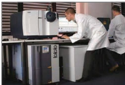
Parker Domnick hunter 针对 Agilent 6400 QQQ 系列和 6500 Q-TOF 系列 LC/MS 对氮气的特殊要求专门设计 LCMS64/65 氮气发生器, 同时产生两路气体, 一路产生纯度 > 98% 的洁净、干燥、无邻苯二甲酸酯氮气作为干燥气、保护气、雾化气, 另外一路产生纯度 > 99.999% 的高纯氮气作为碰撞气, 此外高纯氮气还可以作为 GC 气相的载气!
